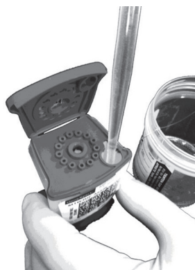
Малюнок 5. Розміщення деконтамінованої розрідженої проби в камеру для проби картриджа
