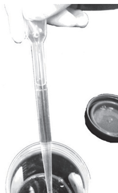
Figure 4. Aspiration jusqu'au repère sur la pipette
