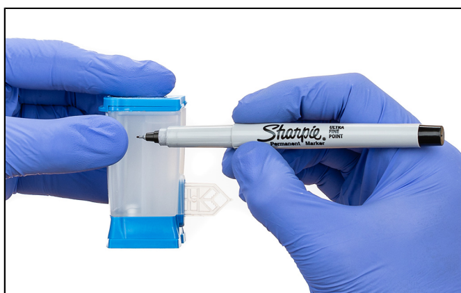
Ilustracja 4. Zapisywanie informacji na bocznej powierzchni kartridża.
