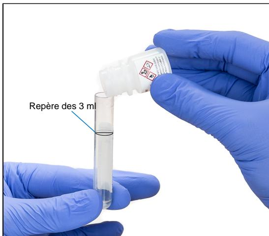
Figure 3. Exemple de dilution à 2:1 (2 ml de SR:1 ml de crachat)
