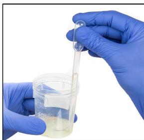
Figure 5. Aspiration jusqu'au repère sur la pipette
