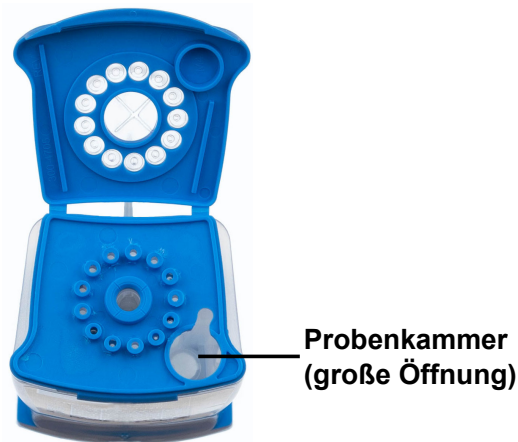
Abbildung 1. Xpert MRSA/SA SSTI-Kartusche (Ansicht von oben)
