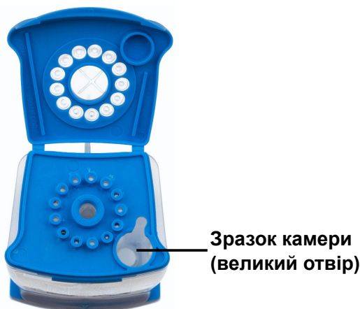
Рисунок 1. Картридж Xpert Breast Cancer STRAT4 (вид зверху)
