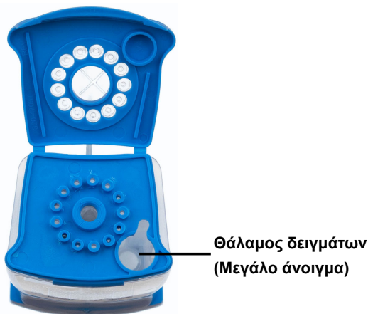
Εικόνα 1. Φύσιγγα Xpert Breast Cancer STRAT4 (Κάτοψη)
