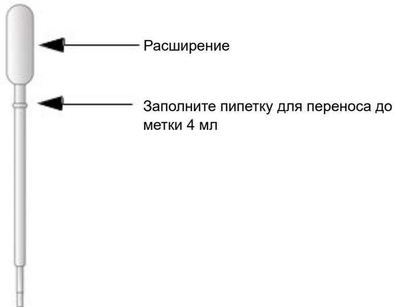
**Рисунок 1. Пипетка для переноса Хpert Bladder Cancer Monitor**
