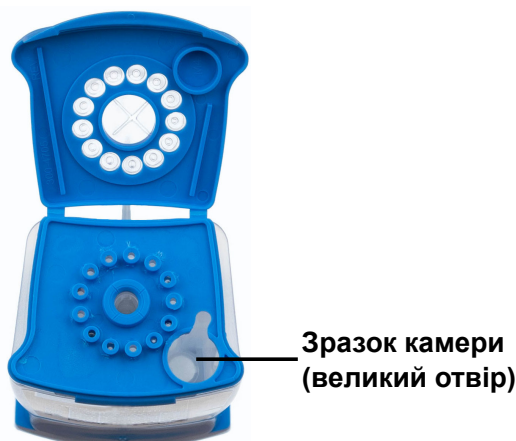
Рисунок 2. Картридж тесту Xpert Bladder Cancer Detection (вигляд згори)
