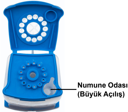
Şekil 2. Şekil 2. Xpert HPV Kartuşu (Üstten Görünüm)
