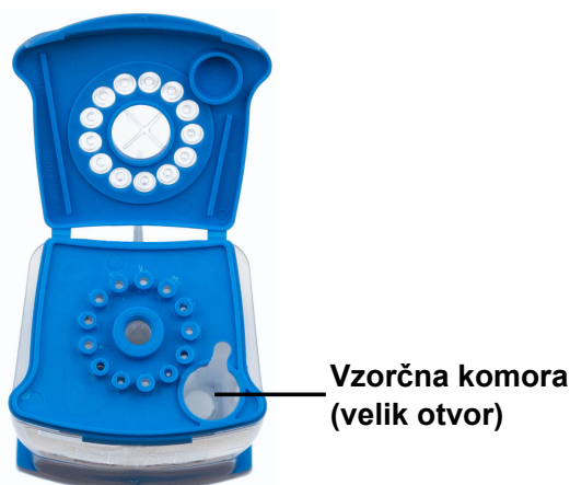
Slika 2. Slika 2. Vložek Xpert HPV (pogled od zgoraj)
