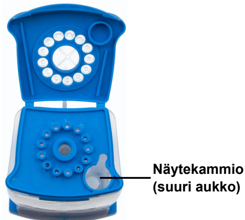
Kuva 5. Xpert Xpress SARS-CoV-2/Flu/RSV -kasetti (kuva ylhäältä)
