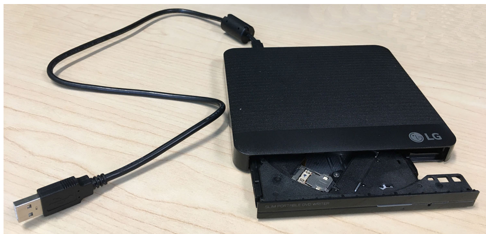
Hình 6. Ổ đĩa DVD được cung cấp, được minh họa với Cửa nạp đang mở
