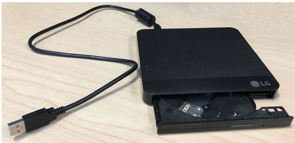
Joonis 6. Kaasasolev DVD-draiv, näidatud avatud laadimislauuga
