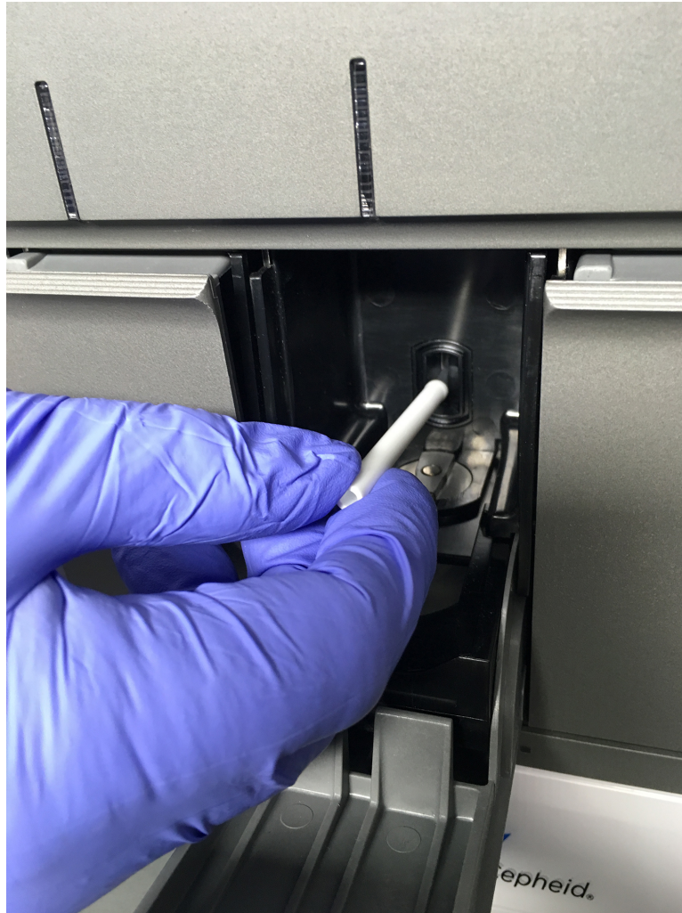
Figur 85. Införing av rengöringsborsten i I-CORE-modulslitsen
