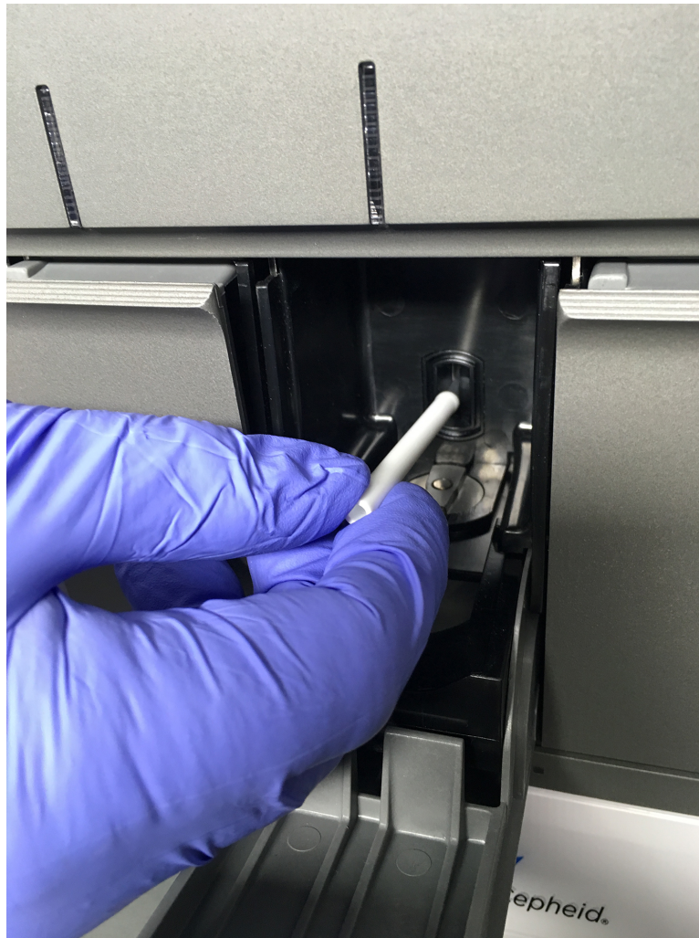
Figura 85. Introducción del cepillo de limpieza en la ranura del módulo I-CORE
