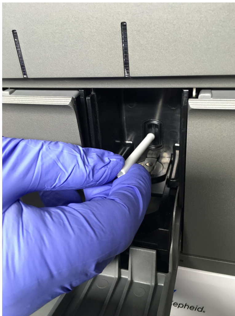
Figura 85: Inserção da escova de limpeza na ranhura do módulo I-CORE
