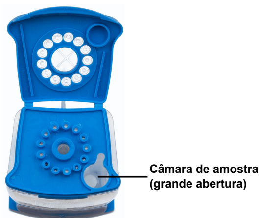
Figura 5: Xpert Xpress SARS-CoV-2/Flu/RSV Cartucho (vista de cima)
