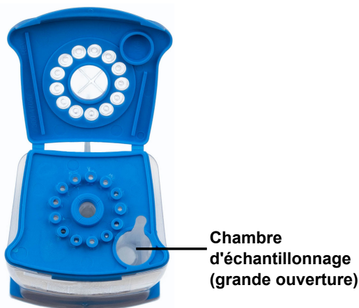
Figure 5. Xpert Xpress SARS-CoV2 Cartouche (vue de dessus)
