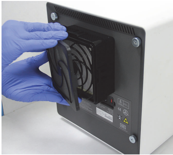
图 9-18. 取下预滤棉固定框
