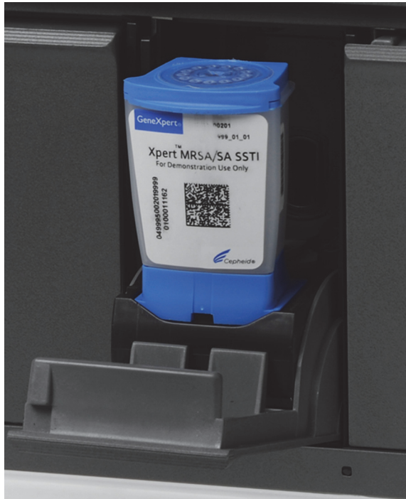
图 5-29. GeneXpert 样品匣位于模块仓底部的跟部
