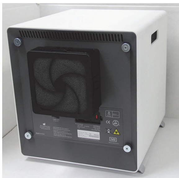
图 9-17. GX-IV 仪器调整到便于操作过滤器的位置
