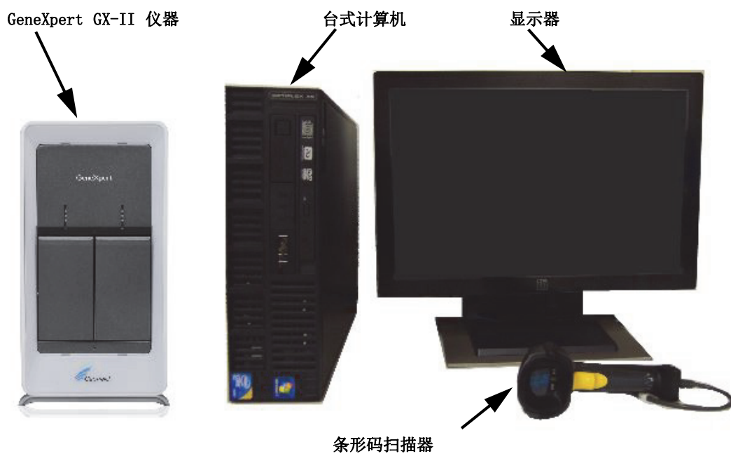
图 1-2. GeneXpert GX-II 硬件组件（以台式计算机示例）
