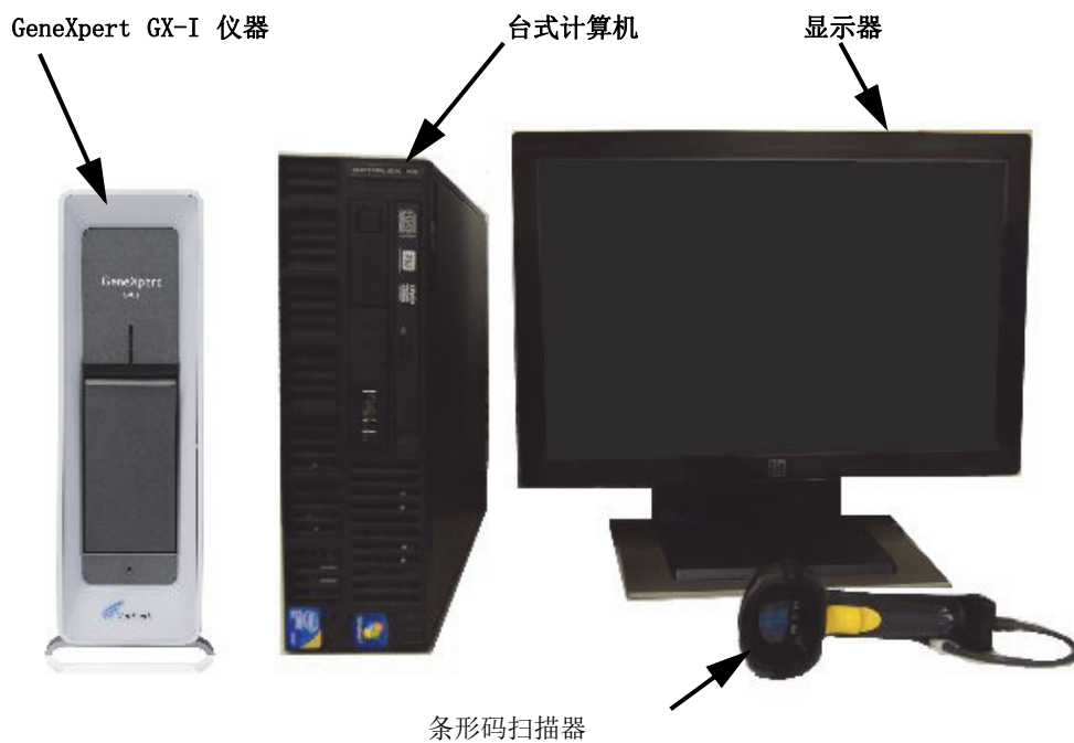
图 1-1. GeneXpert GX-I 硬件组件（以台式计算机示例）
