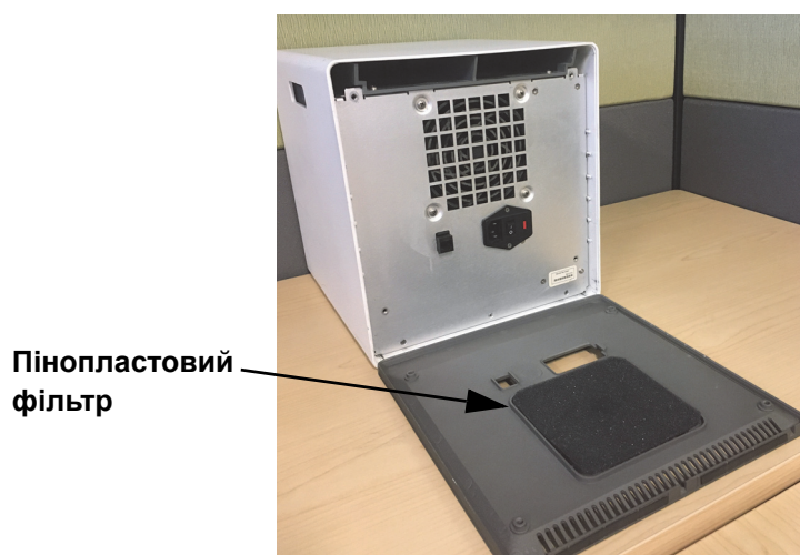
Рисунок 9-15. Пінопластовий фільтр у старій моделі GX-IV
