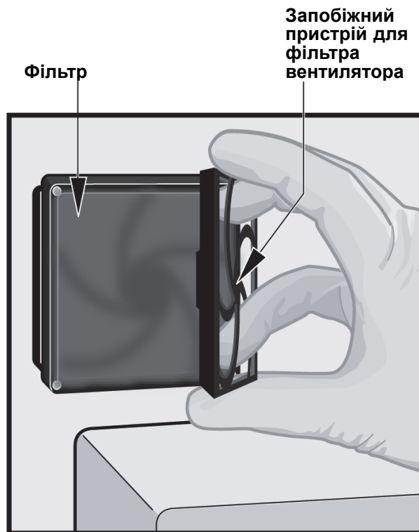
Малюнок 9-22. Видалення запобіжного пристрою для фільтра вентилятора та фільтра
