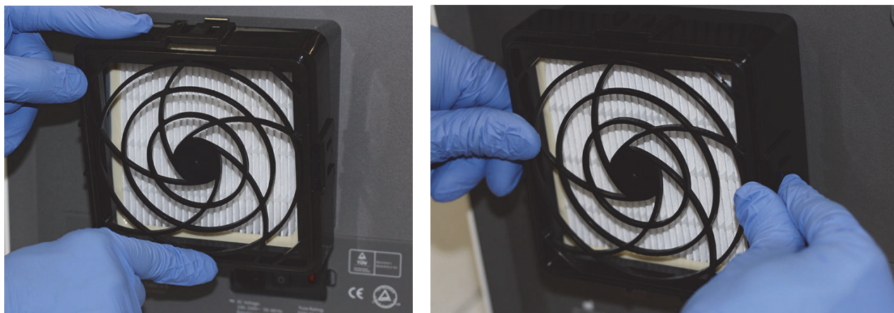
Малюнок 9-30. Заміна утримувача HE фільтра
