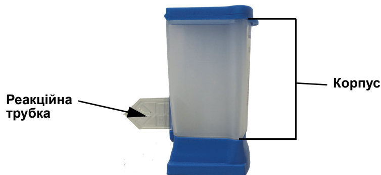
Малюнок 5-27. Зображення корпусу картриджа та реакційної трубки
