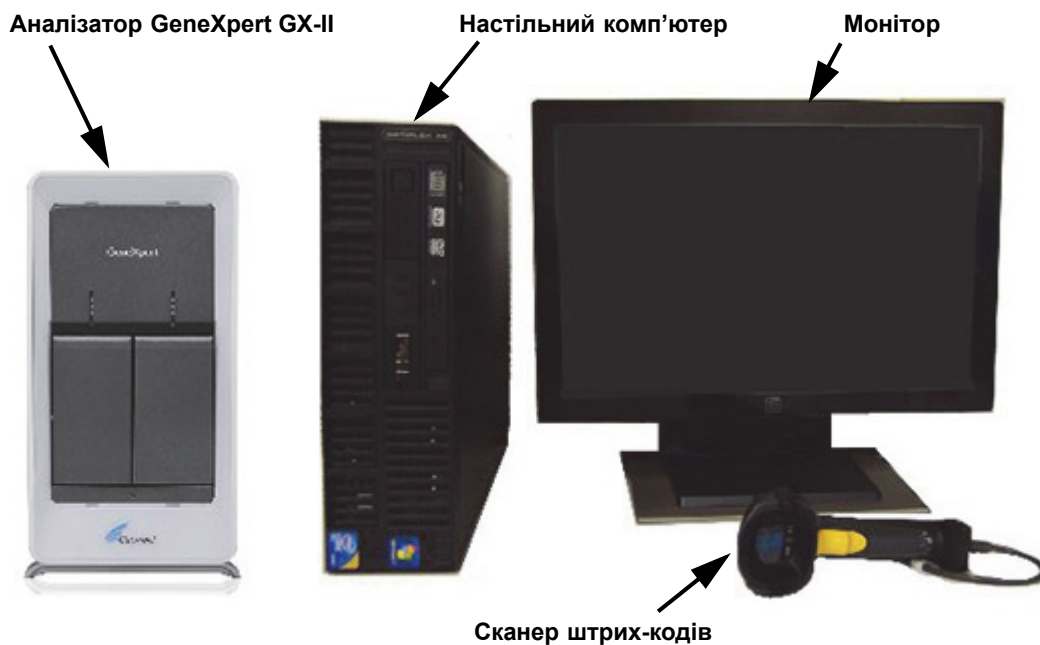
Малюнок 1-5. Апаратні компоненти GeneXpert GX-II (представлені разом з настільним комп'ютером)
