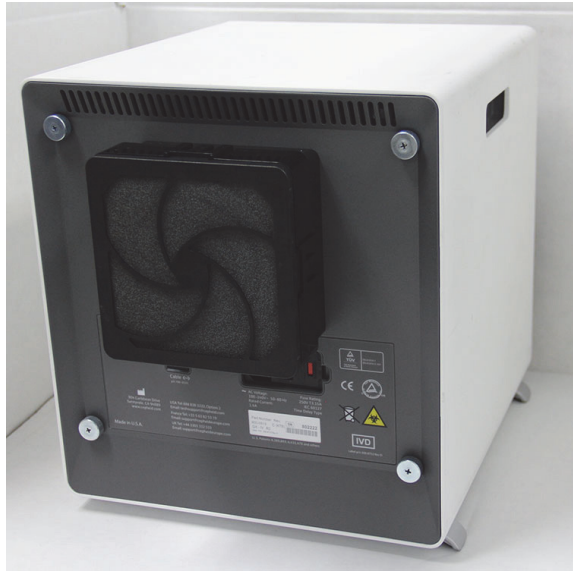
Малюнок 9-24. Аналізатор GX-IV, розташований для доступу до фільтра
