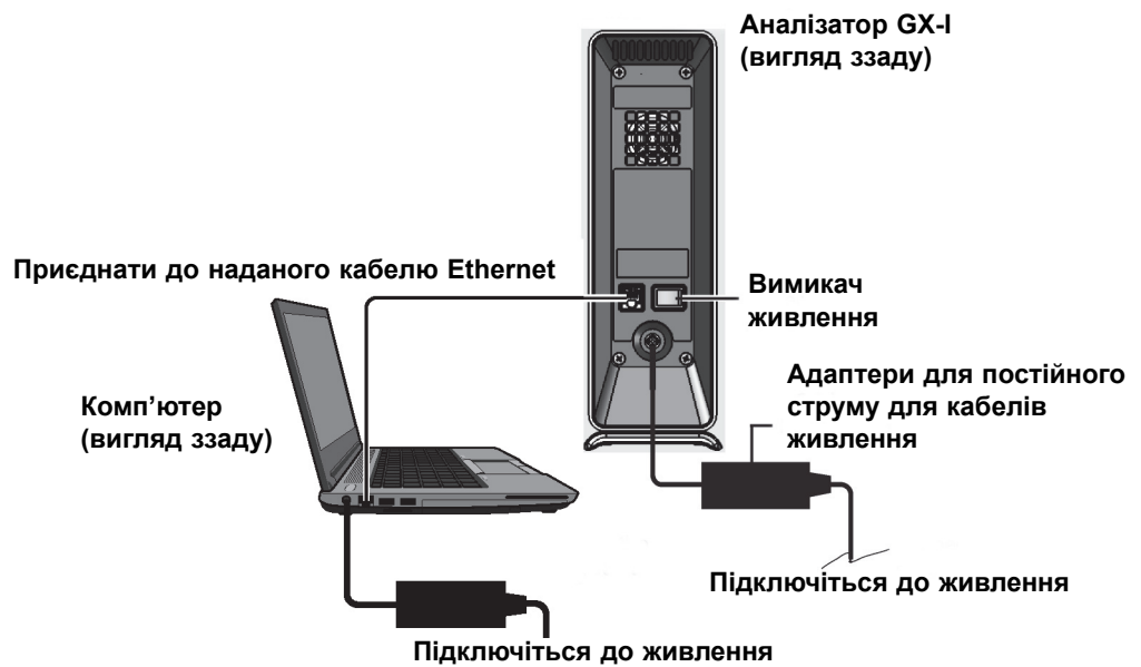
Малюнок 2-5. Підключення аналізатору GX-I до переносного комп'ютера
