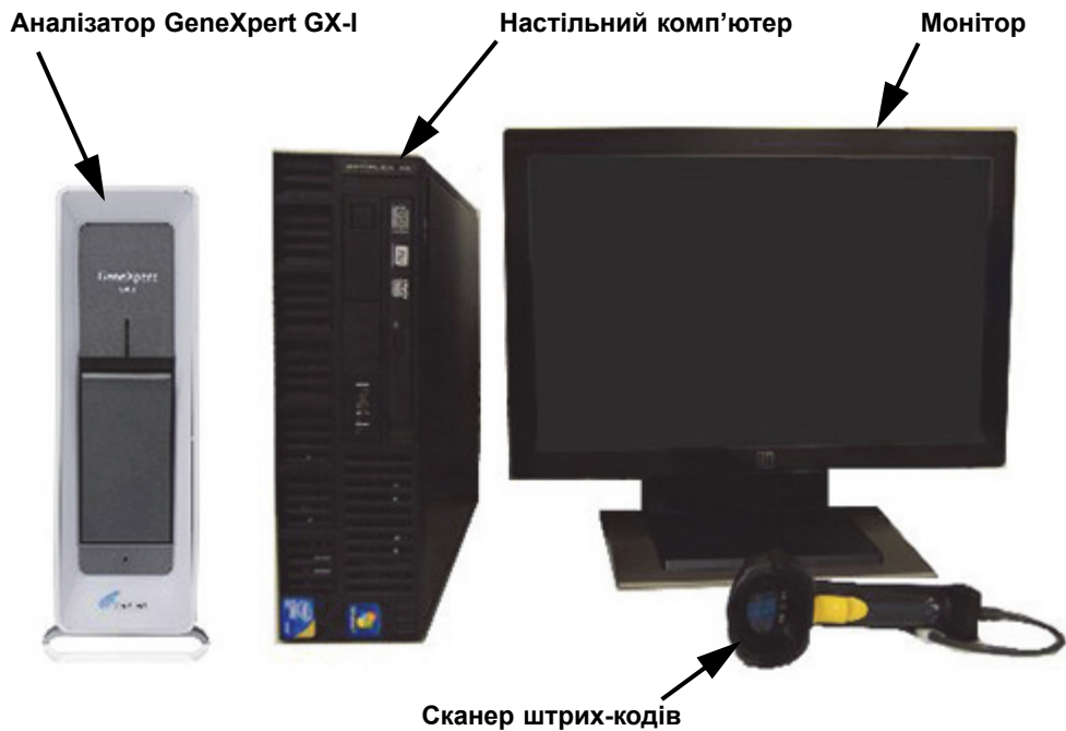
Малюнок 1-3. Апаратні компоненти GeneXpert GX-I (представлені разом з настільним комп'ютером)
