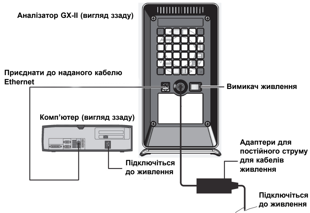
Малюнок 2-2. Підключення аналізатору GX-II до настільного комп'ютера
