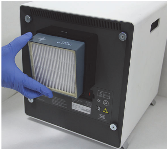
Малюнок 9-29. Заміна HE фільтра
