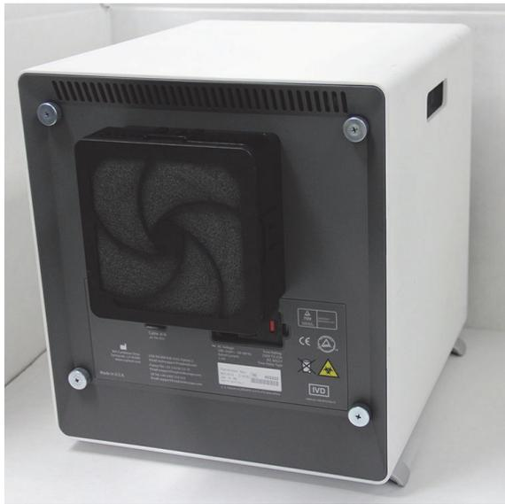
**Figura 9-24. Instrumento GX-IV posicionado para acesso ao filtro**
