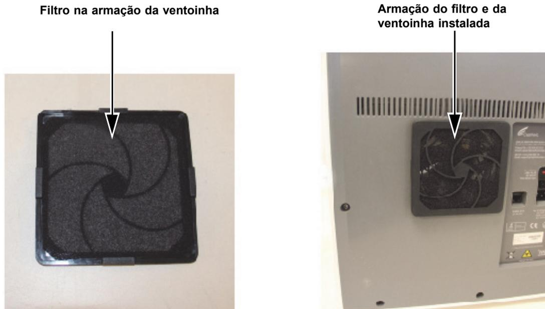
**Figura 9-23. Substituir o filtro e a armação**
