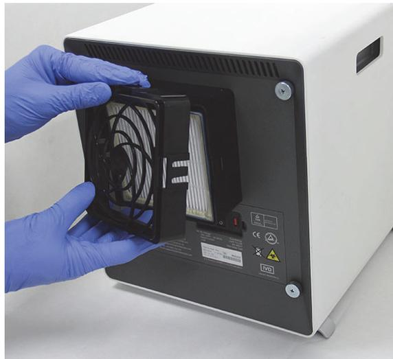
**Figura 9-27. Remoção do retedor do filtro HE**
