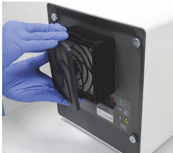
**Figura 9-25. Remover o retentor do pré-filtro**
