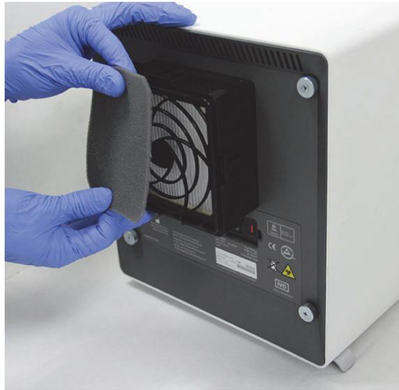
**Figura 9-26. Remoção do pré-filtro**
