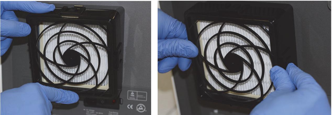
**Figura 9-30. Substituição do retentor do filtro HE**
