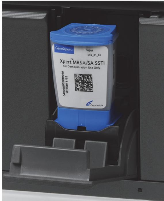
**Figura 5-29. Cartucho GeneXpert, posicionado junto do calço da parte inferior do compartimento do módulo**
