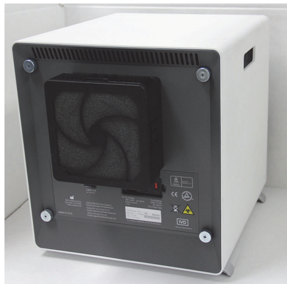
Gambar 9-24. Instrumen GX-IV Diposisikan untuk Mengakses Filter
