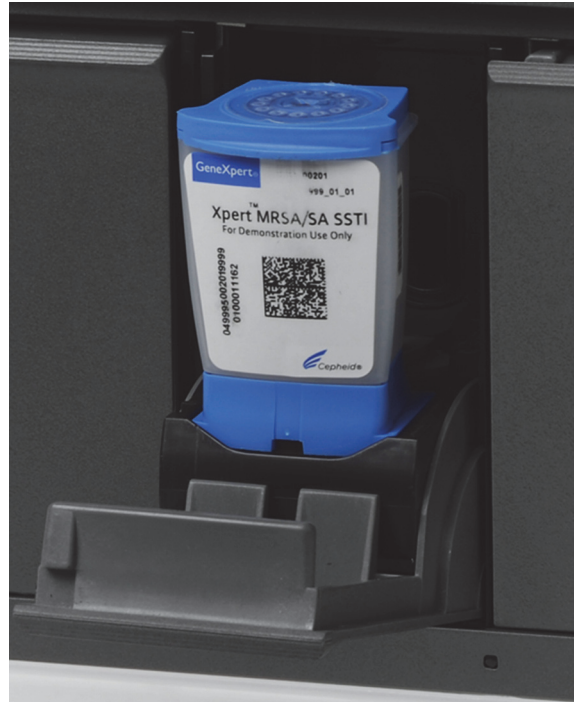
Gambar 5-29. Kartrid GeneXpert, Ditempatkan di Ujung Lantai Ceruk Modul
