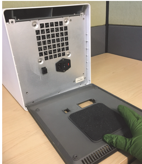
Gambar 9-16. Memasang Kembali Filter Busa pada GX-IV Model Lama
