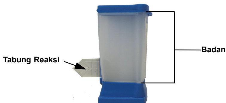
Gambar 5-27. Kartrid yang Memperlihatkan Badan dan Tabung Reaksi
