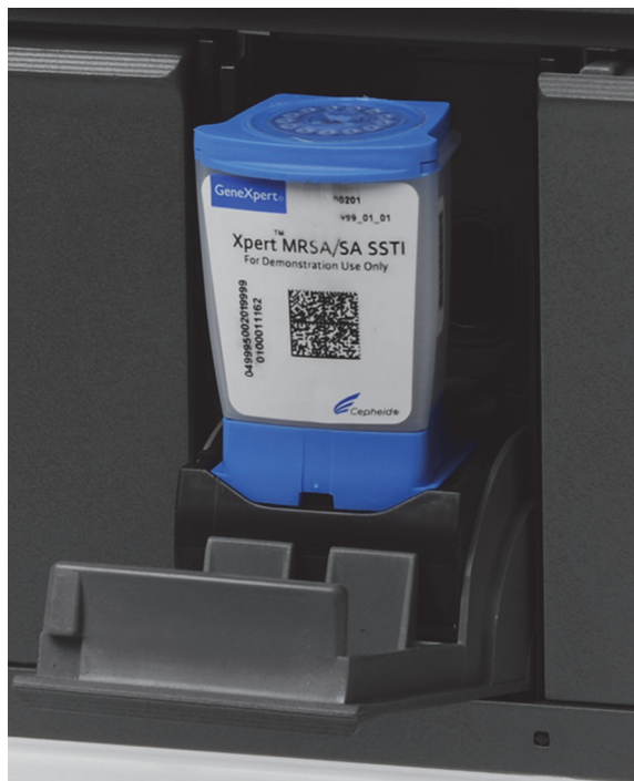
Ilustracja 5-29. Kartridż GeneXpert umieszczony w tylnej części podstawy wnęki modułu
