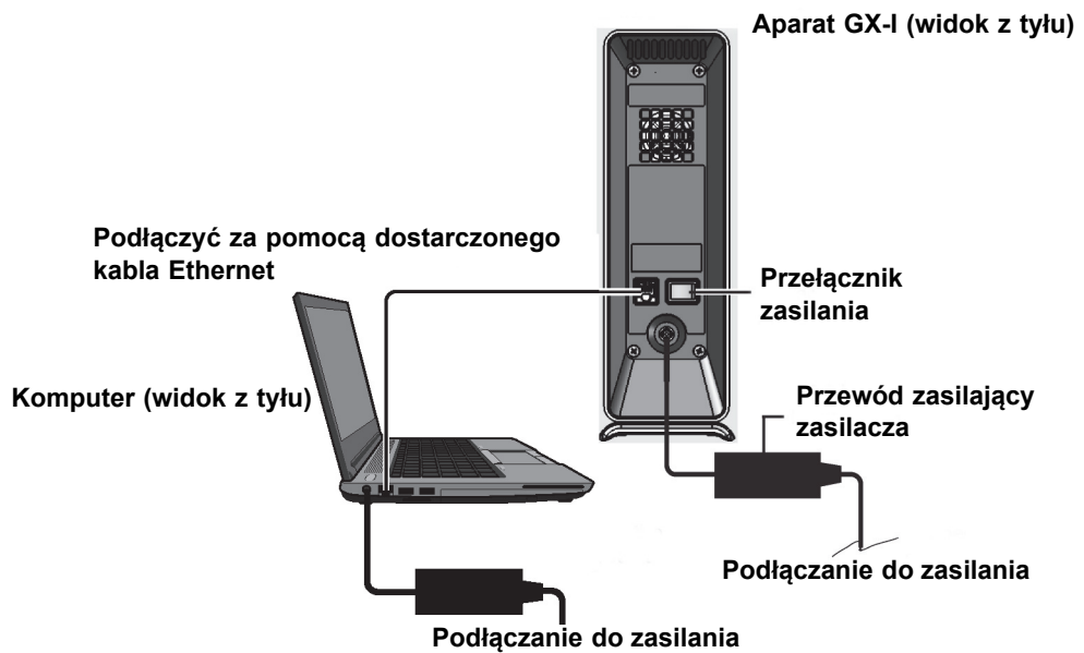
Ilustracja 2-5. Podłączenie aparatu GX-I do laptopa
