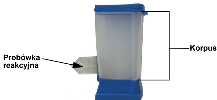
Ilustracja 5-27. Prezentacja kartridża pokazująca korpus i próbkę reakcyjną
