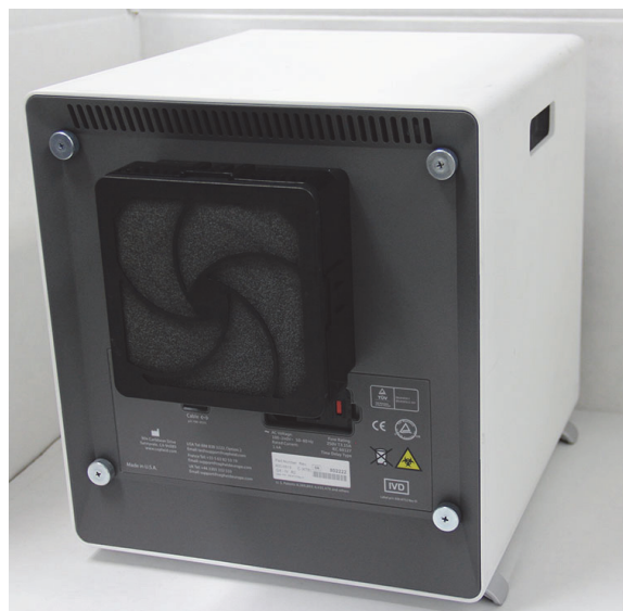
Ilustracja 9-19. Aparat GX-IV ustawiony w sposób umożliwiający dostęp do wentylatorów
